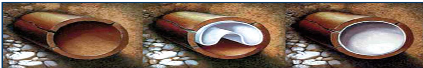
Renowacja rur wykładziną ściśle pasowaną (CIPP) [Inżynier budownictwa]
